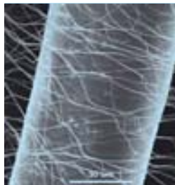
Winzig, hohl, porös und unglaublich vielseitig: Die Nanofasern der Universität Marburg unter dem Elektronenmikroskop (quer verlaufend). Im Vergleich dazu: in menschliches Haar (senkrecht)
