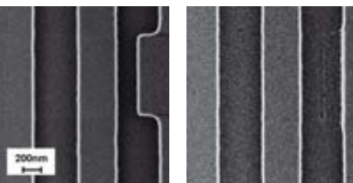
Reparatur im Nanokosmos: Hier wurde mit dem Gerät von NaWoTec überschüssiges Material (links) von der Maske entfernt (rechts).
