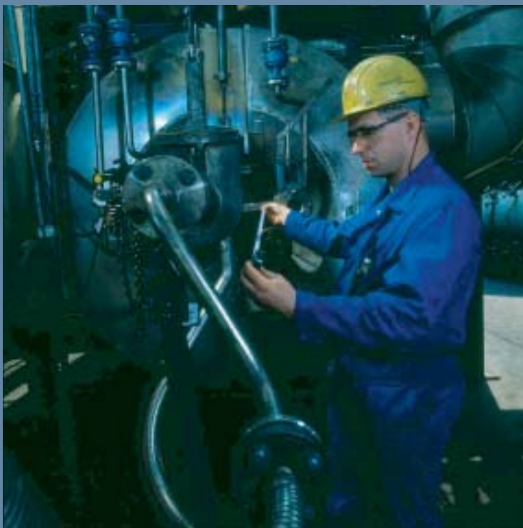
Kritischer Blick: Die Qualität des entstehenden Carbon Black wird ständig durch Probenahmen an verschiedenen Stellen des Reaktors (oben links) und durch die Überwachung der Flamme im Ofen (rechts unten mit Blaufilter gegen die Helligkeit) kontrolliert. Der so genannte Furnacereaktor (oben rechts, unten links) ist ein lang gestrecktes Rohr von mehreren Metern Länge, in dem unter genau definierten Bedingungen flüssige oder gasförmige Kohlenwasserstoffe unvollständig verbrannt werden.
