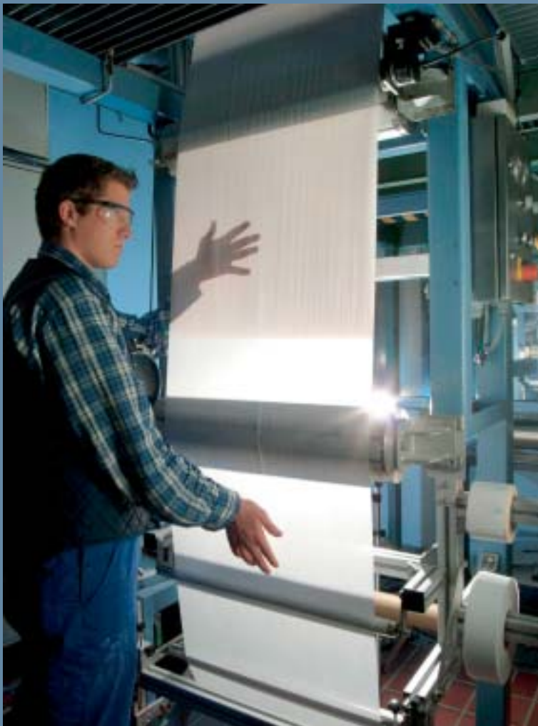
Endlose Keramik: Die Herstellung von SEPARION® erfolgt in einem kontinuierlichen Prozess, bei dem ein hauchdünnes Vlies keramisch beschichtet wird. Neben dem menschlichen Auge wird die Qualität über optische Inspektionssysteme kontrolliert.
