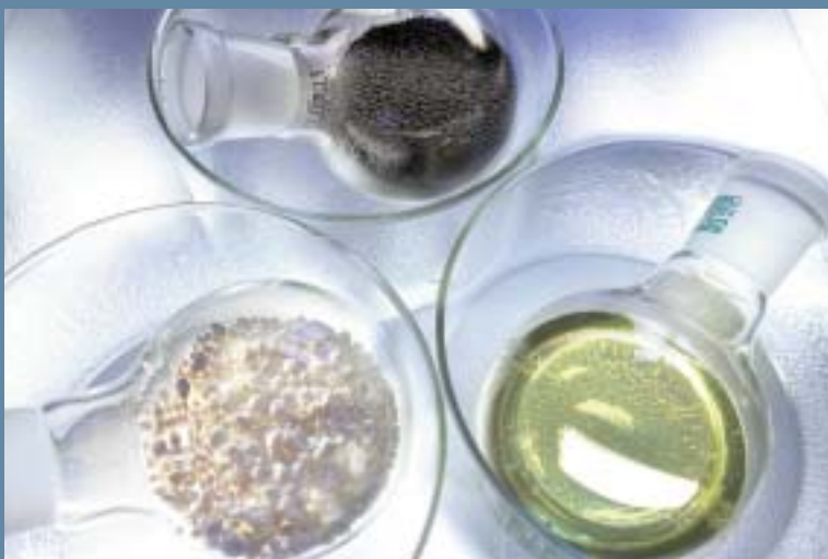
Zutaten zum Spritsparen: Als weltweit einziger Hersteller bietet Degussa alle drei Verstärkerkomponenten für Reifencompounds aus einer Hand an. Maßgeschneiderte Ruße (Carbon Black, im Foto oben) tragen ebenso zur Straßenhaftung, zum Abriebwiderstand und zum Rollwiderstand bei wie Silica (unten links) und Organosilane (unten rechts). Zusammen mit modernen Kautschuken ergeben sie die Basis für den kostengünstigen und umweltfreundlichen Reifen.
