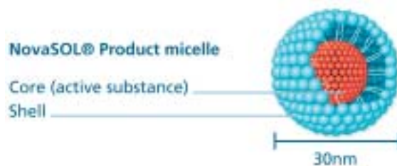
Produkt-Mizelle aus einem Wirkstoff-Kern und einer Hülle aus Detergentien zur Anpassung an das Trägermedium.
