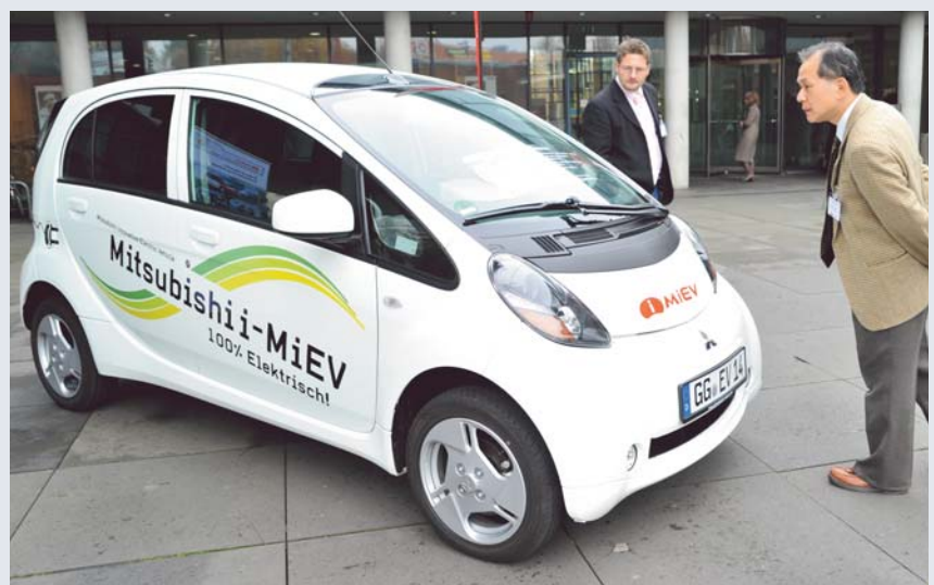
Mit einem Batteriegewicht von 17% seines Gesamtgewichtes erreicht der i-MiEV erstmals Dimensionen, die eine Großserienproduktion ohne zusätzlichen Verbrennungsmotor rechtfertigen. Seine kompakten Maße sind speziell für den Stadtverkehr ausgelegt.
