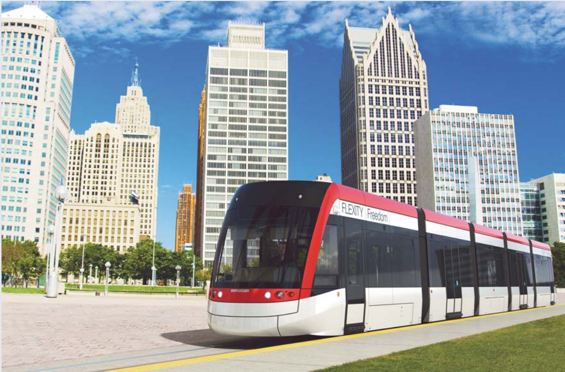
Stadtbahn der Zukunft: Durch Rückgewinnung und Zwischenspeicherung von Bremsenergie wird bis zu 30 Prozent an Energie eingespart. (Quelle: Bombardier)
