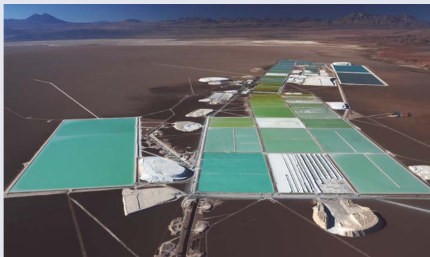
Hauptquelle zur Lithiumgewinnung aus der Natur: Trocknung von Salzlauge, hier in der chilenischen Atacama-Wüste. Die gezeigten Trocknungsbecken haben eine Ausdehnung von 4 x 9 km. (Quelle: Chemetall)
